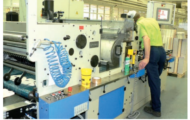
Einrichten der Fenstereinklebe- maschine F-1440/2 Servo.
